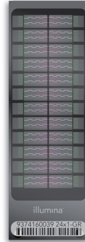
그림 1: BovineSNP50 v3 BeadChip — 소의 유전체 전체에 걸쳐 균등한 간격으로 분포하는 53,218개의 SNP로 구성된 BovineSNP50 v3 BeadChip
