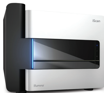
Abbildung 1: Das iScan-System: ein vollautomatisches System, das mit automatischen Beladungsrobotern und Laborinformations- und Managementsystemen (LIMS) kompatibel ist und eine zuverlässige Scan-Lösung mit hohem Durchsatz bietet.
