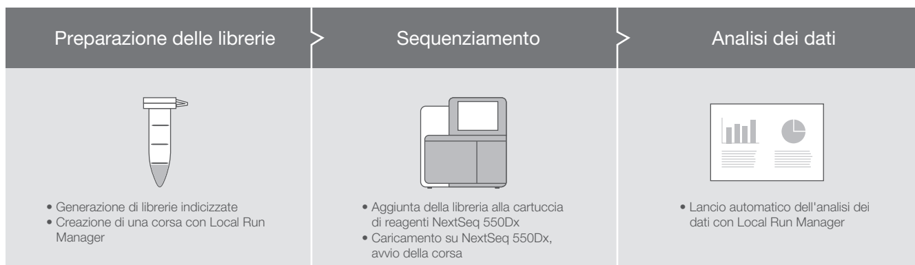
Figura 2: Processo in tre fasi del saggio NextSeq 550Dx: lo strumento NextSeq 550Dx fa parte di un processo integrato costituito da tre fasi. Con il saggio TruSeq™ Custom Amplicon Dx sono disponibili dettagliati report dei risultati.
