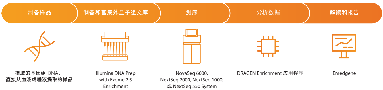
图 1: 从样品到报告, 只需一个合作伙伴 — Illumina 支持一站式的 WES 工作流程。提取的 gDNA (或按照直接提取操作流程从血液或唾液中提取出的 DNA) 是 Illumina DNA Prep with Exome 2.5 Enrichment 的文库制备输入。精选方法适用于一系列自动化平台。根据规模和通量需求在 Illumina 仪器上进行测序。使用 DRAGEN Enrichment 应用程序执行准确、快速的二级分析和变异检出。对于遗传疾病, 可通过 Emedgene 进行直观的解读和报告。
