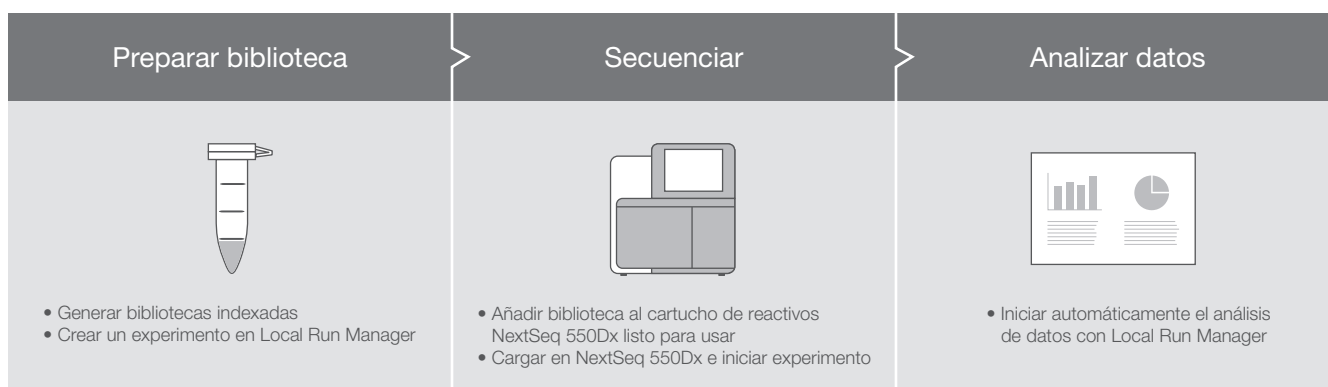
Figura 2: Proceso de ensayo de NextSeq 550Dx en tres pasos. El instrumento NextSeq 550Dx forma parte de un proceso integrado de tres pasos. Con el ensayo TruSeq™ Custom Amplicon Dx Assay se dispone de informes de resultados detallados.
