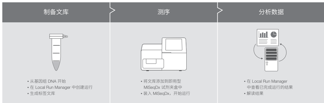
图 2: 三步 MiSeqDx 实验分析方法流程 — MiSeqDx 仪器是集成流程的一部分, 整个流程包括分子诊断实验分析方法的文库制备和数据分析。仅会对特异性目标的实验分析方法 (例如 TruSight Cystic Fibrosis 139-Variant Assay 和 TruSight Cystic Fibrosis Clinical Sequencing Assay) 提供详细的结果报告。
