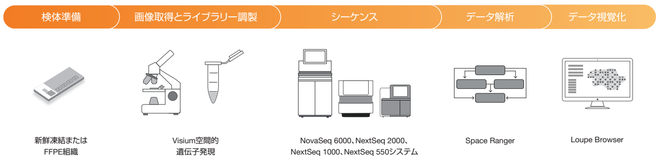
図1: 空間的RNA-Seq実験のワークフロー: 新鮮凍結またはFFPE組織切片をVisium空間的遺伝子発現スライドに貼り付け、組織切片を染色し画像を取得します。ガラススライドはバーコード付加オリゴヌクレオチドプローブでmRNAを捕捉し、cDNA合成後にライブラリーを構築します。全トランスクリプトーム遺伝子発現ライブラリーをイルミナ装置でシーケンスします。10x GenomicsのSpace RangerおよびLoupe Browserを用いて遺伝子発現位置と組織形態を結び付けます。
