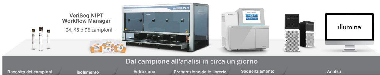
Figura 1: Flusso di lavoro NIPT completo per IVD: il VeriSeq NIPT Solution v2 fornisce tutto il necessario per il test NIPT utilizzando la tecnologia NGS, inclusi i reagenti per l'estrazione del DNA, la preparazione delle librerie e il sequenziamento; strumentazione per la preparazione delle librerie e il sequenziamento automatizzati mediante il Workflow Manager Software; un server onsite sicuro per l'archiviazione dei dati e l'analisi; un software per l'analisi dei dati in grado di generare un report con risultati qualitativi.
