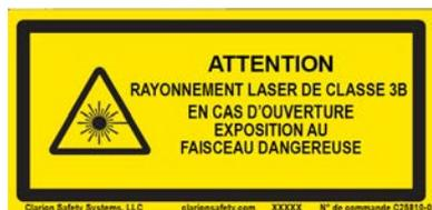
Figure 4 Étiquette de mise en garde relative aux dangers du laser : traduction française
