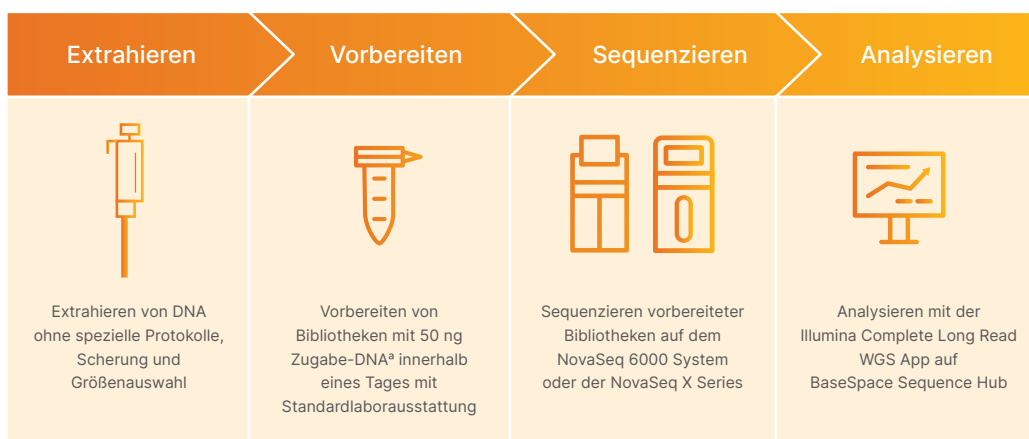
Abbildung 1: Illumina Complete Long Read-Workflow: Zugriff auf umfassende Long-Read-WGS-Daten anhand eines skalierbaren, optimierten Protokolls für die Bibliotheksvorbereitung, der Sequenzierung auf dem NovaSeq 6000 System oder der NovaSeq X Series und der DRAGEN-Sekundäranalyse. Eine standardmäßige WGS-Bibliothek mit 30-facher Coverage sollte mit der Illumina Complete Long Read-Bibliothek vorbereitet, sequenziert und analysiert werden.
