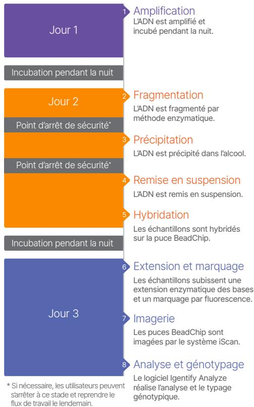
Figure 3 : Flux de travail Infinium LCG – le test Infinium utilise un flux de travail rapide de trois jours avec une durée de manipulation minimale.
