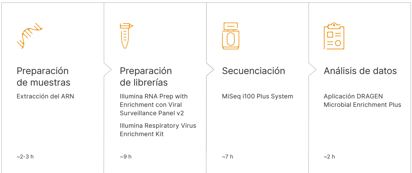
Figura 1: Flujo de trabajo de NGS completo para la secuenciación de virus de la gripe
