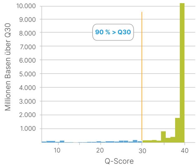
Abbildung 3: Qualitäts-Score-Verteilung des MiSeq System: Qualitäts-Scores für eine PhiX-Kontrollbibliothek, einen Lauf mit  $2 \times 300$  Basenpaaren auf einem MiSeq System mit MiSeq Control Software v2.4. Dieses Beispiel zeigt, dass 90 % der Basen über Q30 sequenziert werden.
