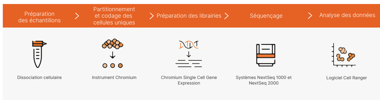
Figure 1 : Flux de travail de Chromium Single Cell Gene Expression : une expérience de scRNA-Seq typique comporte un flux de travail de préparation des échantillons, de partitionnement et de codage cellulaires, de préparation des bibliothèques, de séquençage et d'analyse des données.
