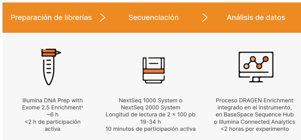
Figura 1: Flujo de trabajo de secuenciación de exomas de NextSeq 1000 y NextSeq 2000. NextSeq 1000 System y NextSeq 2000 System forman parte de un flujo de trabajo de NGS sencillo e integrado que ofrece datos de secuenciación de exomas de alta precisión. Los tiempos variarán en función del tipo de ensayo y de experimento.
