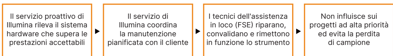
Figura 1: Esempio di come funziona il servizio proattivo di Illumina : in questo esempio, il monitoraggio di routine dei dati delle prestazioni del sistema fornisce il rilevamento del rischio di guasto che consente di pianificare la manutenzione quando si eseguono progetti con alta priorità. Viene così evitata una potenziale perdita di tempo, sforzi e campione.
