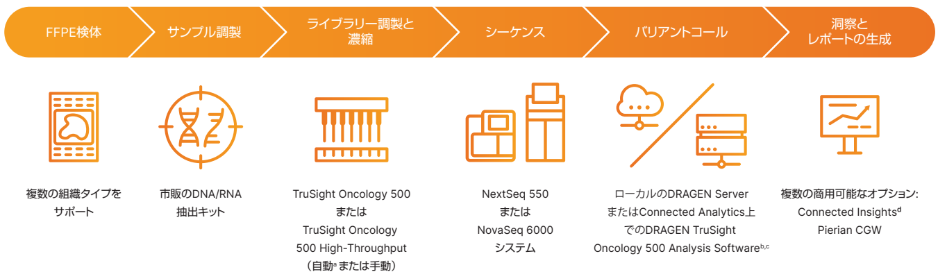
図2: TruSight Oncology 500のワークフロー: TruSight Oncology 500およびTruSight Oncology 500 High-Throughputはラボの既存のワークフローに統合でき、核酸からバリエントコールまで4日間で完了します。
